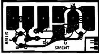
TOUCH CONTROL ASSEMBLY (COMPONENT SIDE)
